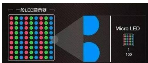
图 37: Micro LED 实现了芯片微缩化
