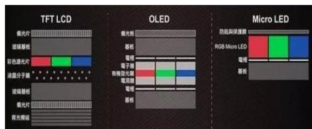
图 38: TFT-LCD、OLED、Micro LED 显示原理对比
